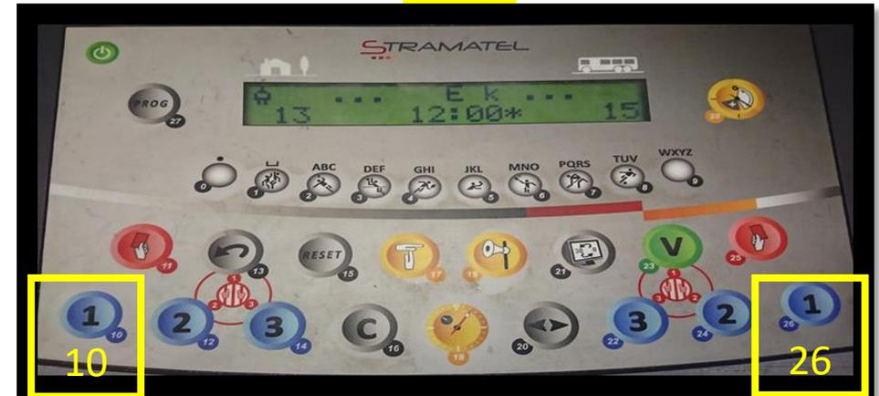
Une fois le temps-mort lancé : retirer 1 temps-mort en appuyant simultanément sur 16 et sur 10 ou 26.
